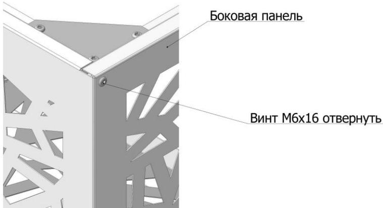
6.2. Соберите защитный козырек. Для этого закрепите боковые стенки на крышке при помощи винтов М6 х 16. Рис. 14.
