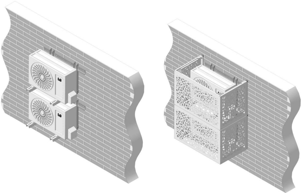
7.2. Монтаж декоративных ограждений в вертикальной плоскости начинается у установки нижнего ограждения. Зазор между монтажными траверсами должен составлять 4 – 5 мм. Рис. 17.
