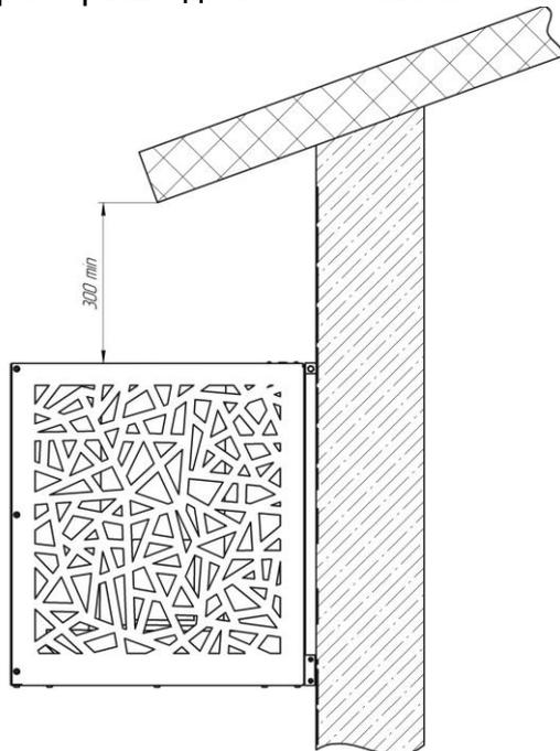
6.1. Для установки защитного козырька на декоративное ограждение внешнего блока сплит системы отверните два винта М6 х 16 в верхней части боковых панелей. Рис 13.
