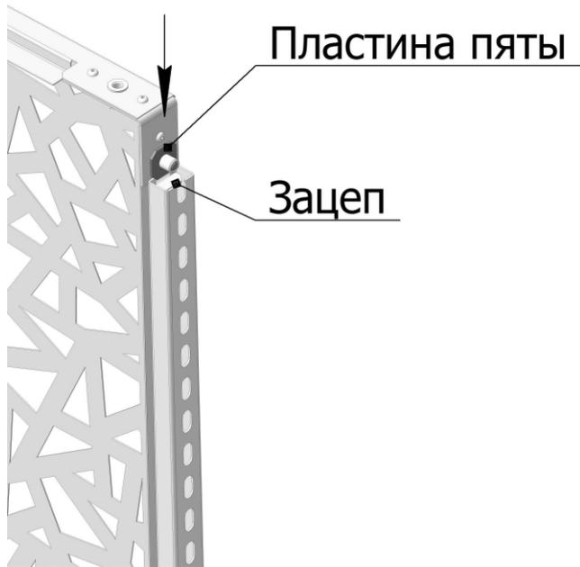
4.2. Поднесите декоративное ограждение к монтажным траверсам и вставьте зацеп, расположенный на тыльной стороне боковой стенки, и шайбу пяты внутрь профиля траверсы. Рис. 7.
