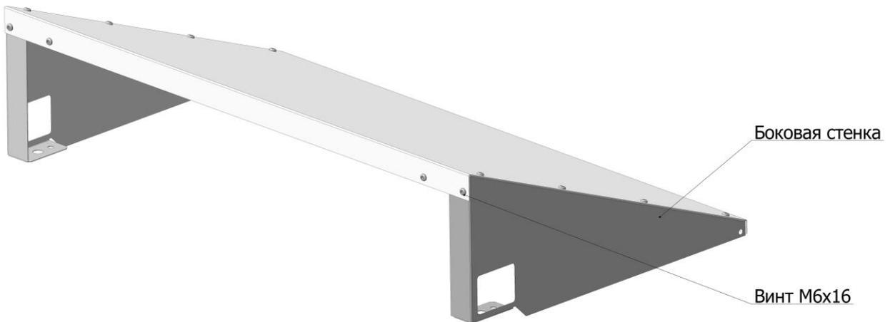
6.3. Установите защитный козырек на декоративное ограждение и закрепите при помощи двух винтов М6 х 16 и двух болтов М8 х 20. Рис. 15.
