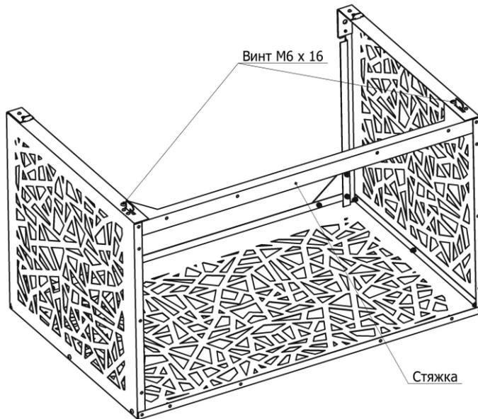
3.5. Установите планки на левую и правую боковины и закрепите при помощи винтов М6 х 16. Рис. 4.
